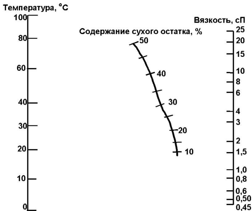
Рис. III. Номограмма для определения вязкости сульфатных, натронных и сульфитных щелоков в зависимости от температуры и содержания сухого остатка ( $1 \text{ сП} = 10^{-3} \text{ Па}\cdot\text{с}$ )
