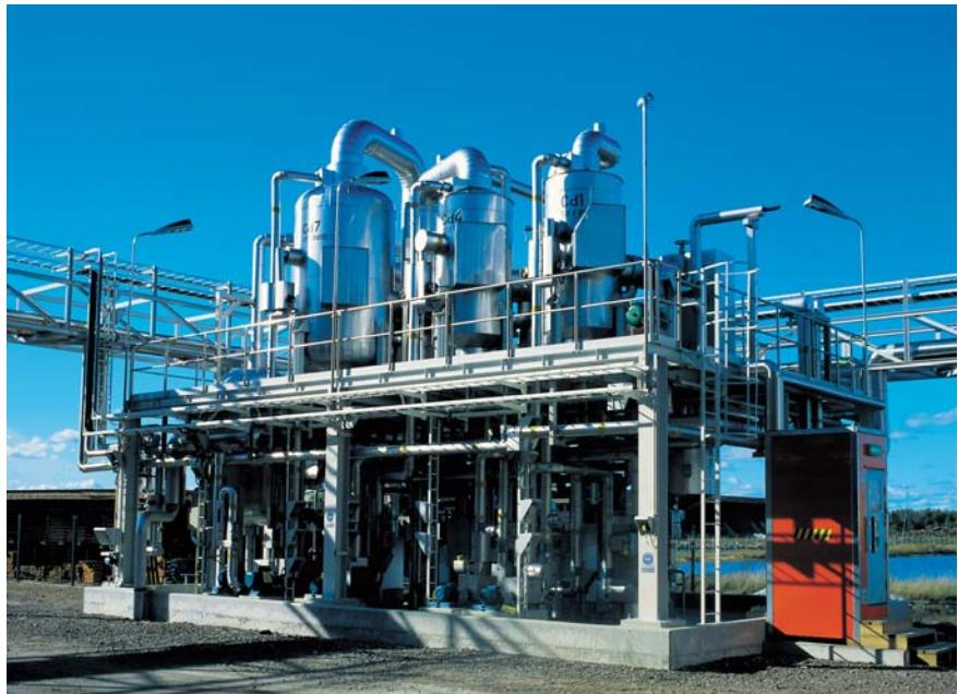
2-ступенчатая выпарная станция с использованием AlfaVap и AlfaCond для концентрирования фруктозы с 55 Brix до 75 Brix (Sensus, Голландия). Малое время пребывания внутри выпарной установки идеально при обработке чувствительной к нагреву фруктозы.
