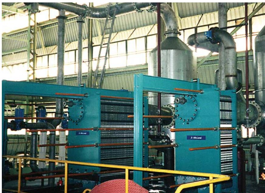
Использование AlfaVap в 2-ступенчатой выпарной системе с термической рекомпрессией на сахароррафинадном заводе в Малайзии. Существовавшая кожухотрубная выпарная станция падающей пленки была способна сконцентрировать сахарный сироп до 71 Brix. Система AlfaVap позволила получать концентрацию сахарного сиропа 75 Brix без рециркуляции при малом времени выпаривания сиропа. Результат - улучшение качества продукта и сокращение времени пуска/остановки выпарной станции.
